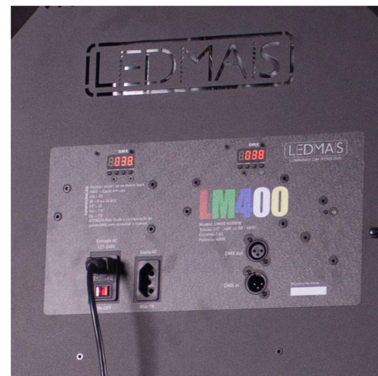
**IMPORTANTE:** Observe que os dois displays digitais na parte de trás do refletor não são um controle manual e sim a maneira de endereçar os canais e alterar algumas configurações técnicas do DMX.
