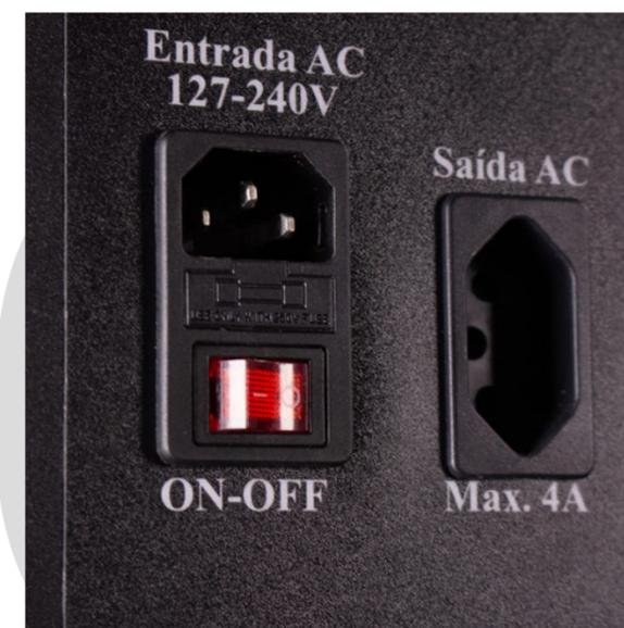
**Atenção:** O LM400 é bivolt, pode ser ligado em 110 V ou 220V mas esta tomada adicional fornecerá sempre a mesma tensão em que o LM400 estiver sendo alimentado - 110V ou 220V.
