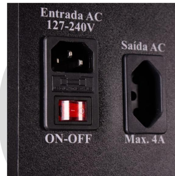
**Atenção:** O LM100B é bivolt, pode ser ligado em 110V ou 220V mas esta tomada adicional fornecerá sempre a mesma tensão em que ele estiver sendo alimentado - 110V ou 220V.
