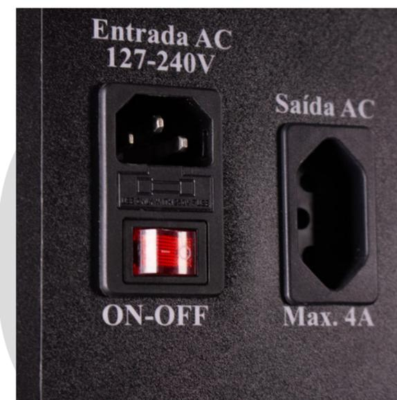
**Atenção:** O LM100 é bivolt, pode ser ligado em 110V ou 220V mas esta tomada adicional fornecerá sempre a mesma tensão em que ele estiver sendo alimentado - 110V ou 220V.
