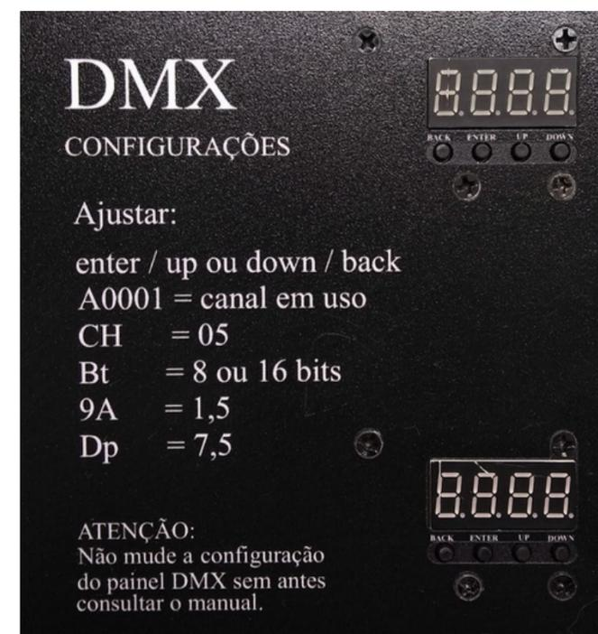
**IMPORTANTE:** Observe que os dois displays digitais na parte de trás da caixa não são um controle manual e sim a maneira de endereçar os canais e alterar algumas configurações técnicas do DMX.
